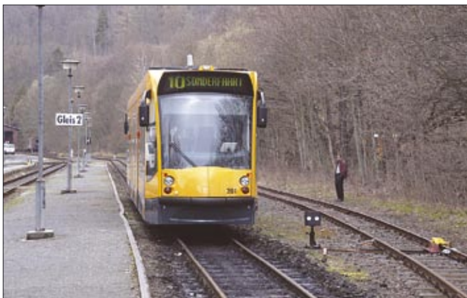
Dieselelektrisk duospårvagn på icke elektrifierad järnväg i Harz i Tyskland, nära staden Nordhausen. I trafik sedan maj 2004.
