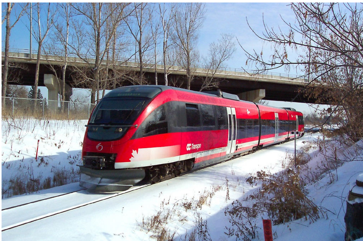
Figur 2.16: Eksempel på moderne dieseltog fra Bombardier af typen Talent. Toget kan fås i en 2-vognsudgave med ca. 100 siddepladser og i en 3-vognsudgave med ca. 160 siddepladser. Toget har en tophastighed på 140 km/t.
