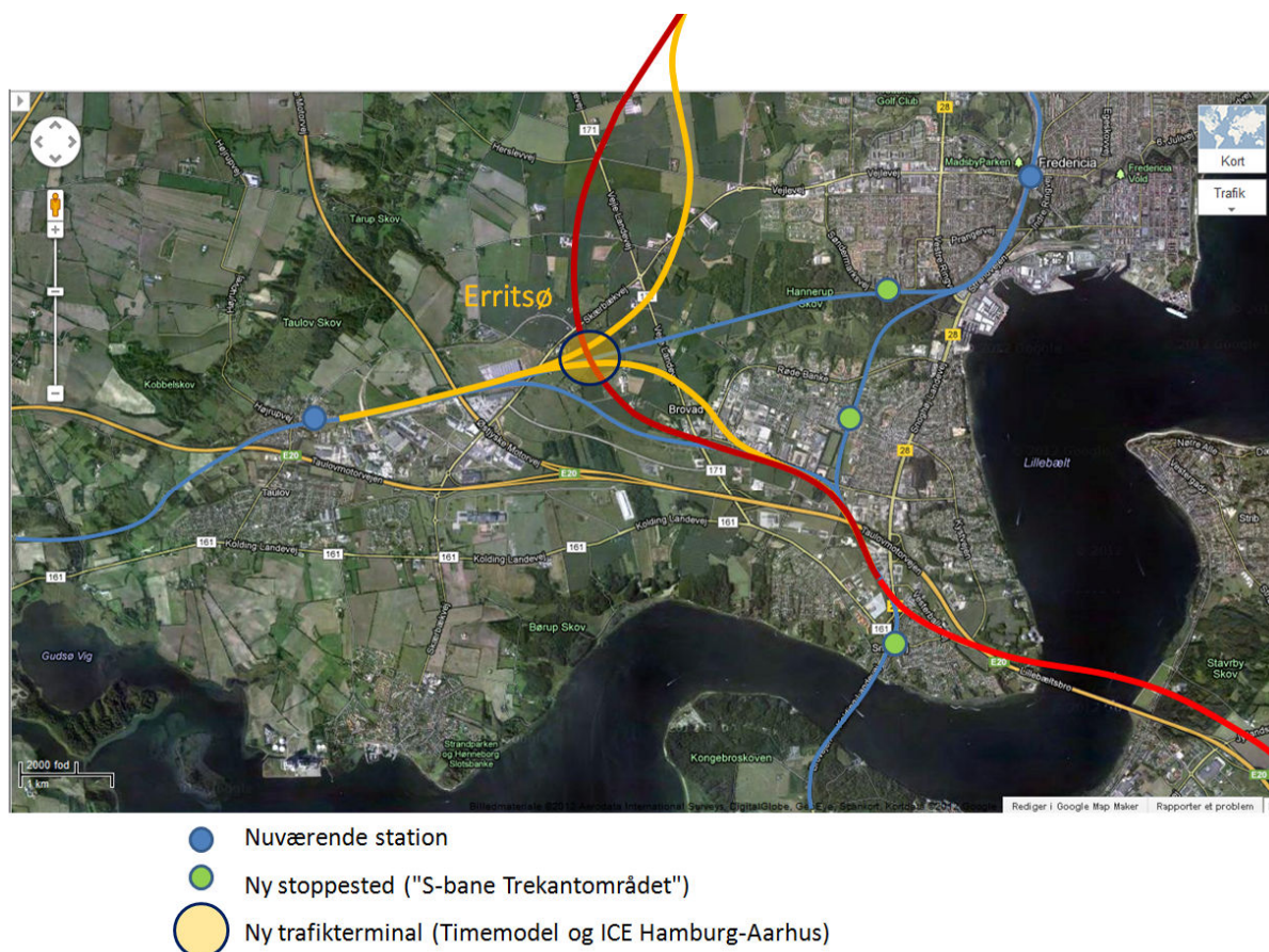
Figur 3.5 En mulig indretning og placering af en fælles højhastighedsstation Erritsø i Trekantområdet. Røde og gule linjer er nyanlæg, mens blå linjer er eksisterende baner.
