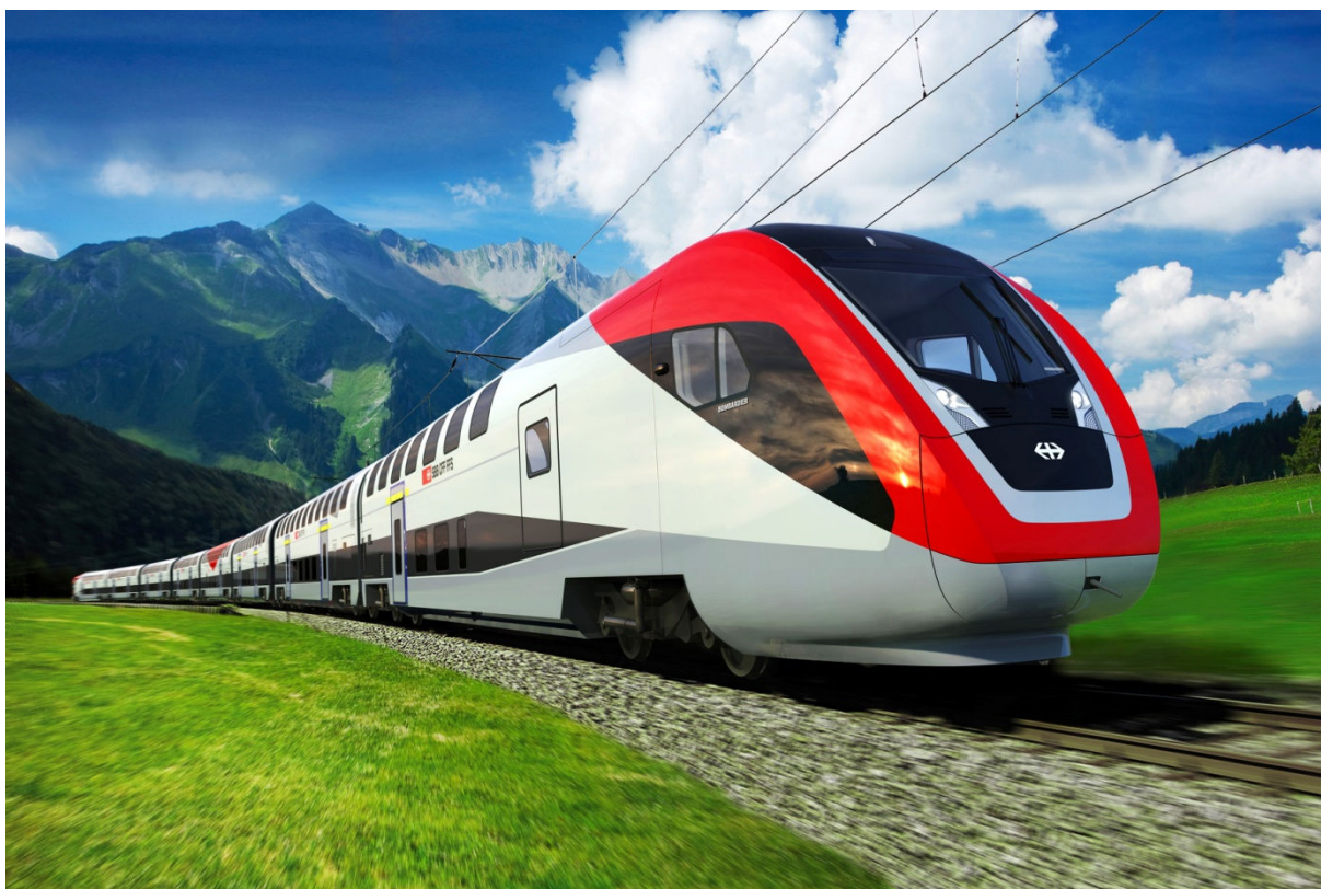
Figur 2.15: Eksempel på et moderne togsæt fra Bombardier Twindexx, der har en tophastighed på 200 km/t. Anvendes i bl.a. Schweiz som har ordre på 59 eksempler med levering mellem 2013-2019. Toget er designet i forskellige varianter, med en kort version der har en toglængde på 100m og 340 siddepladser samt en længere version på over 200m og knap 700 siddepladser.
