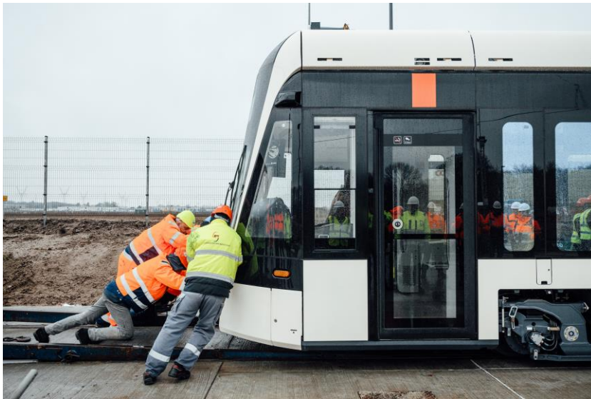
Odense Letbane har lavt energiforbrug pga. lav rullemodstand 4 mand kunne skubbe et 36 m tog på 50 ton. Det svarer til to ledbusser
