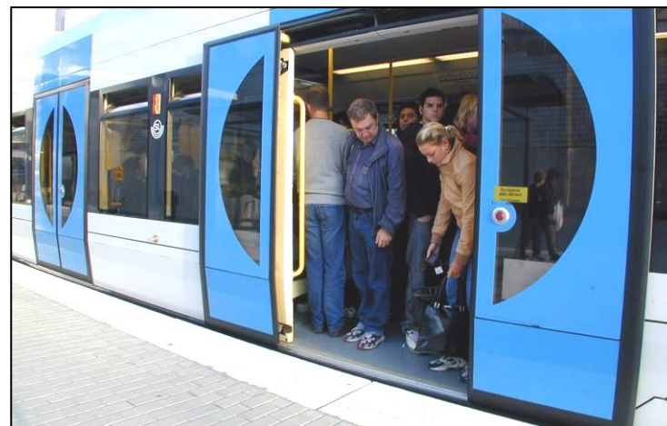
Niveaufri indstigning (Stockholms Tvärbana)
